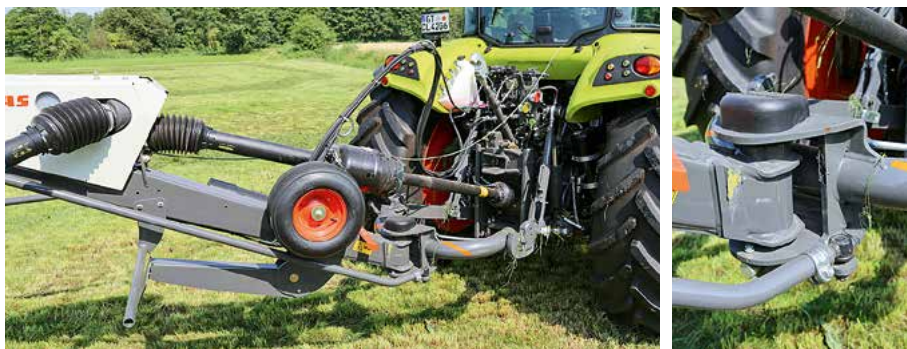
Sauber, aufgeräumt und übersichtlich ist der Anbauraum. Die Anschläge an Bock und Rahmen hat Claas wesentlich verstärkt – sehr gut
