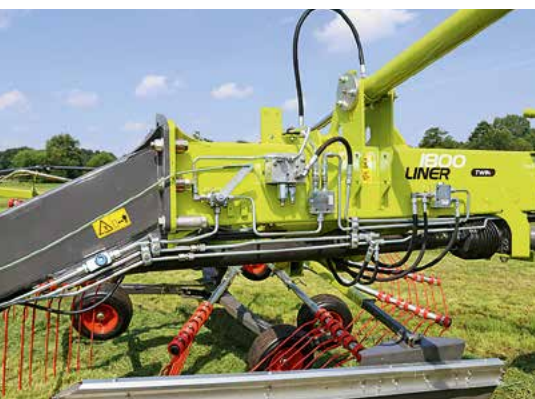
Die Hydraulik ist links gut zugänglich untergebracht. Neben einer Durchflussmengenregulierung lassen sich auch noch das Ausheben und Absenken per Ventil anpassen.
