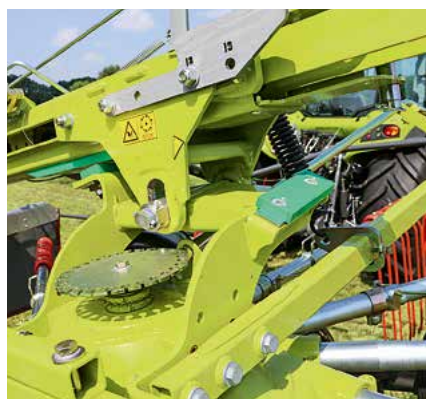
Den Zugpunkt in Form eines Kugelgelenks der kardanischen Aufhängung hat Claas weit nach vorne verlegt. Hinten bietet ein Langloch reichlich Pendelweg.
