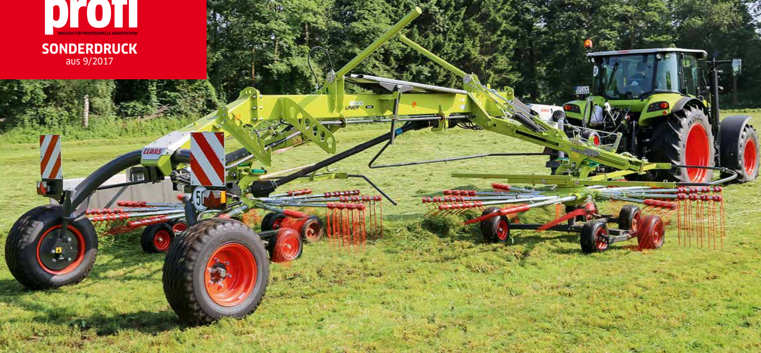
Den Zweikreiselschwader Liner 1800 Twin stellt Claas als Programmergänzung neu vor. Fotos: Brüse
