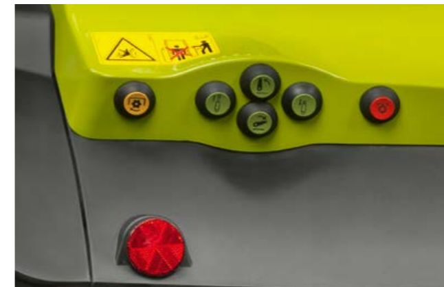
Externe Bedienung für Heckzapfwelle
