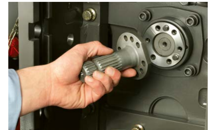
Einfacher Wechsel der Zapfwellenstummel
